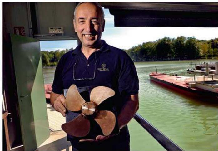
**Elles aussi réduites à l'échelle 1/25<sup>e</sup>, les hélices des embarcations sont la reproduction exacte des modèles originaux. La majorité de ces pièces sont usinées sur place.**
