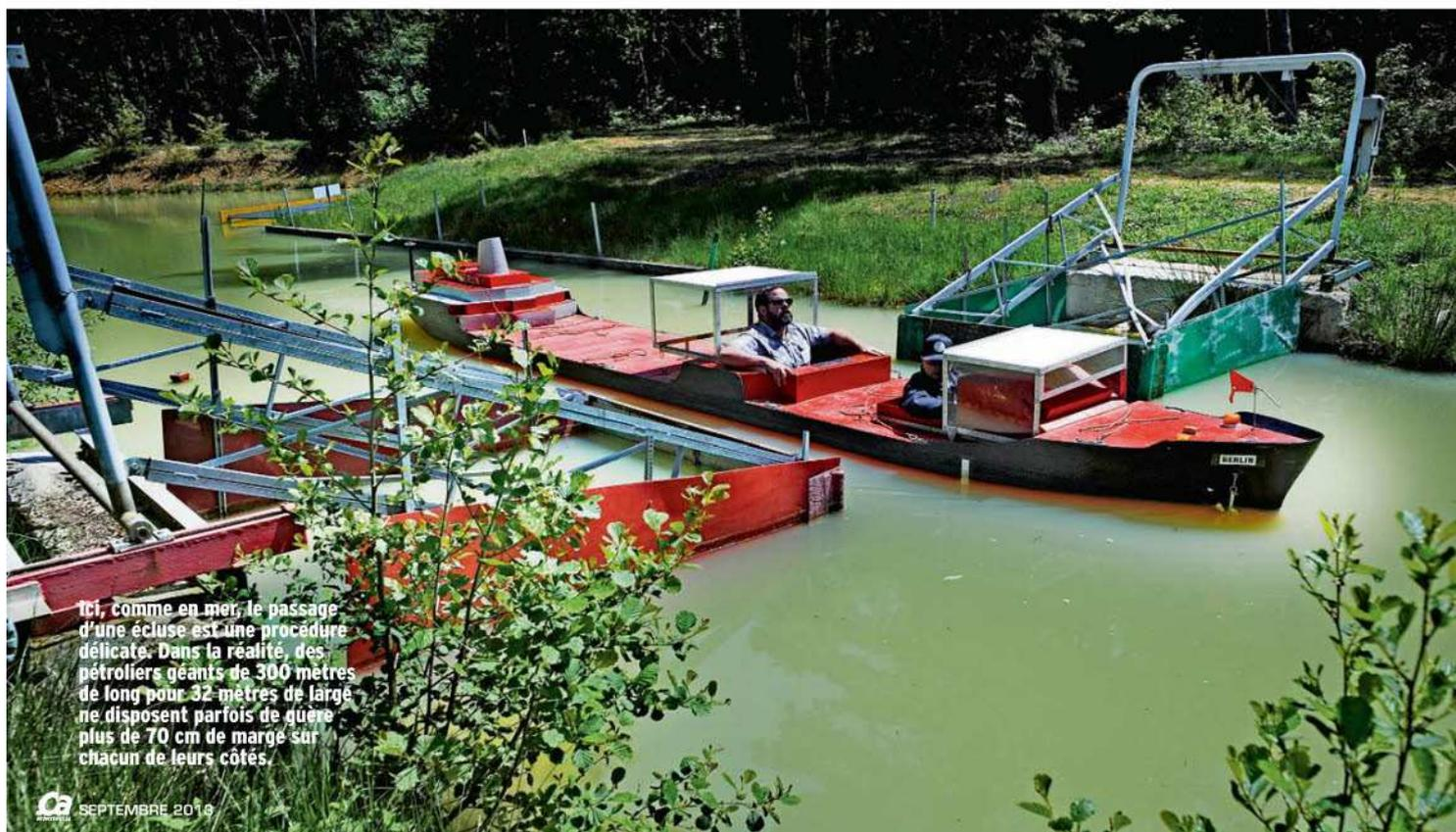
Ici, comme en mer, le passage d'une écluse est une procédure délicate. Dans la réalité, des pétroliers géants de 300 mètres de long pour 32 mètres de large ne disposent parfois de guère plus de 70 cm de marge sur chacun de leurs côtés.
