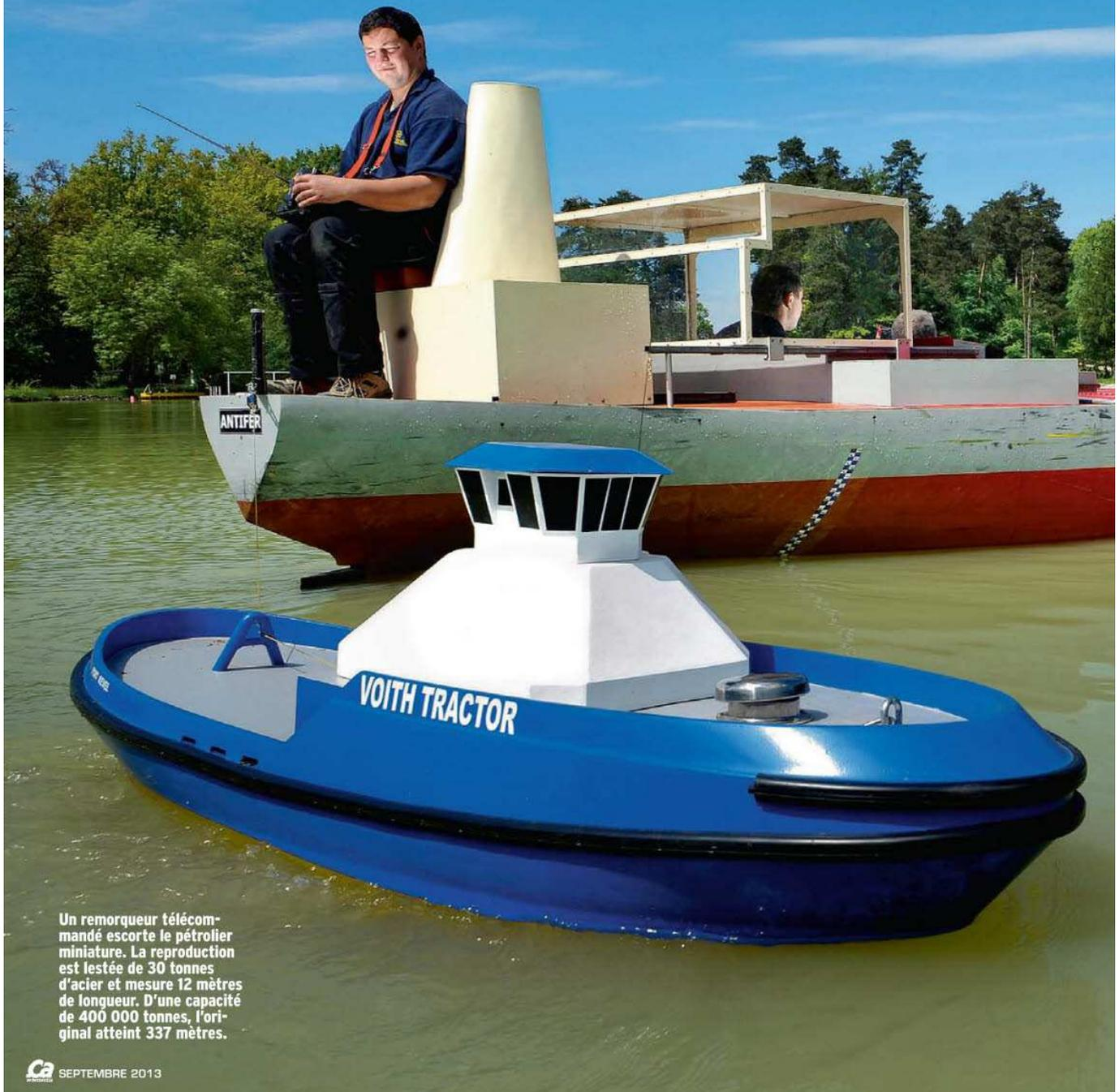
Un remorqueur télécommandé escorte le pétrolier miniature. La reproduction est lestée de 30 tonnes d'acier et mesure 12 mètres de longueur. D'une capacité de 400 000 tonnes, l'original atteint 337 mètres.
