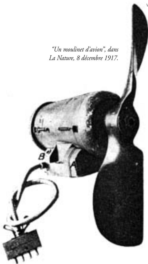
de petites hélices à axe horizontal, avec deux, trois ou quatre pales, parfois une seule, et elles tournaient extrêmement vite, contrairement aux moulins traditionnels et aux multipales. Leur puissance était de quelques centaines de watts et leur électricité servait aux appareils photographiques, à la radio, aux instruments de navigation, à l'éclairage, au chauffage, etc.
